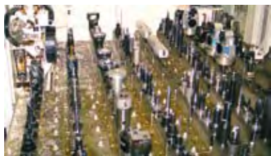
使用编码块对加工中心的刀具进行识别。应用于Friedrichshafen的MTU公司。
