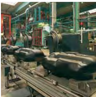
Kautex公司塑料水箱生产线上的货盘识别
