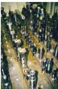
使用编码块对加工中心的刀具进行识别。应用于Friedrichshafen的MTU公司。
